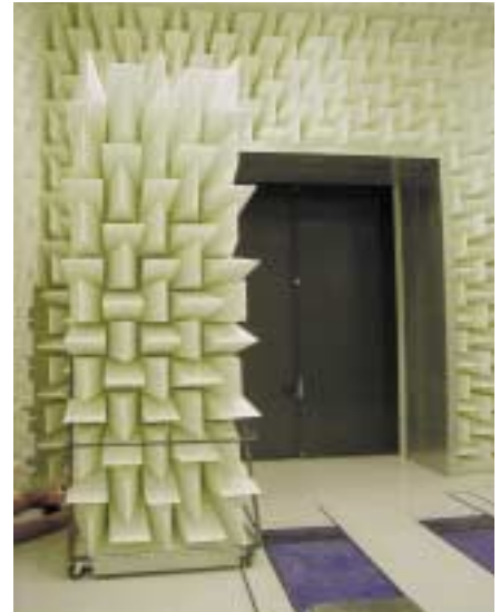
Salle semi anéchoïque 975m 3 fréquence de coupure 50Hz
